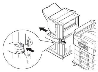
**2.** Betätigen Sie die Freigabetaste (2) der Duplexabdeckung und öffnen Sie die Abdeckung.
