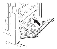
**9.** Bringen Sie den Finisher wieder in die ursprüngliche Position und schließen Sie ihn an den Inverter an.
