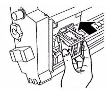
**11.** Achten Sie darauf, dass die Heftpatrone wieder fest in die Hefteinheit eingesetzt wurde, und schieben Sie die Hefteinheit wieder an die ursprüngliche Position.
