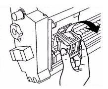
**7.** Heben Sie die Klappe der Heftpatrone an.
