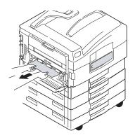
**4.** Betätigen Sie die Hebel (3) und ziehen Sie die Duplexeinheit heraus.
