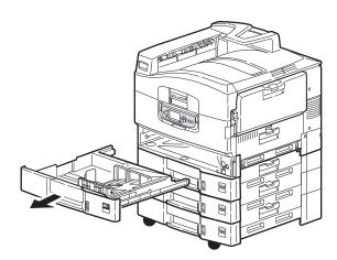
**4.** Führen Sie Ihre Hand in die Öffnung von Fach 1 ein und wischen Sie die drei Papierzufuhrwalzen (2) mit einem trockenen, leicht mit Wasser angefeuchteten Tuch ab.
