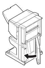
**10.** Bringen Sie Finisher und Inverter wieder in die ursprüngliche Position und schließen Sie die Geräte an den Drucker an.
