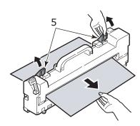
**6.** Setzen Sie die Fixiereinheit vorsichtig wieder in den Drucker ein und drehen Sie den Riegel (6) in die abgebildete Richtung, um die Fixiereinheit zu verriegeln.
