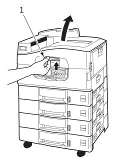
Schließen Sie die obere Abdeckung, indem Sie sie behutsam bis zum Anschlag auf halbem Weg andrücken (1). Drücken Sie die Abdeckung dann fester an, um sie vollständig zu schließen. Achten Sie darauf, dass die Abdeckung fest verschlossen ist.
