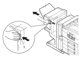
**2.** Drücken Sie den vertieften Hebel (2) und öffnen Sie die linke Seitenabdeckung des Inverters.
