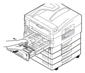
**7.** Überprüfen und beseitigen Sie nach dem gleichen Prinzip gestautes Papier unterhalb der rückwärtigen oberen Abdeckung.
