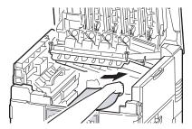
**4.** Wenn Papier in der Fixiereinheit gestaut ist, drücken Sie den Riegel (3) in die abgebildete Richtung, um die Einheit zu lösen.
