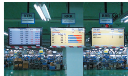
リアルタイム不良報告システムの画面。不良発生時には、工程/部品/原因/対応状況などが表示される。
