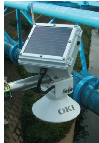
ネットワーク型「ゼロエネルギー超音波水位計」。無線方式と太陽電池の採用により配線工事が不要。
