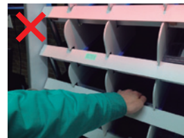
誤って違う部品棚からピックアップしようとする、作業者の後ろにあるカメラとセンサーが検知し、プロジェクターにより棚が赤く投影される
