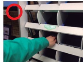
必要な部品が入っている棚が、プロジェクターから投影される緑の矢印で示される
