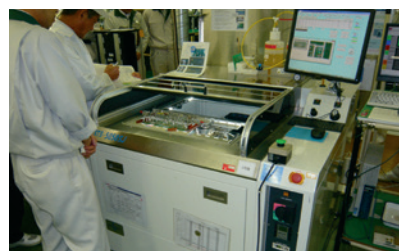
必要な箇所にピンポイントではんだ付けを行なう「ポイントDIP」マシンにより、長野OKIは環境負荷を7割削減
