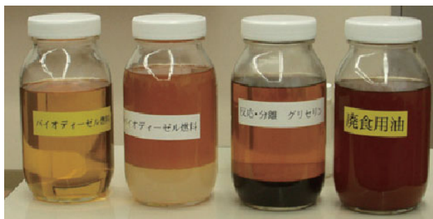
バイオディーゼル燃料の精製工程
