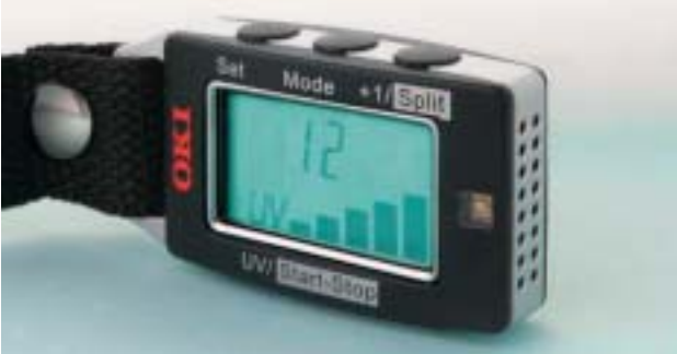
UVセンサーICを内蔵した携帯型アクセサリの試作品
