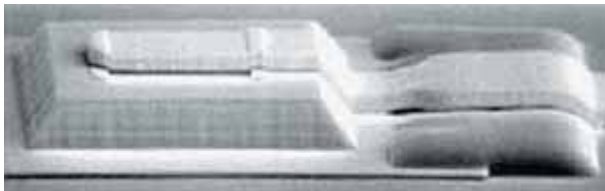
エピ・フィルム・ボンディング技術でドライバICに接合された薄膜LED
