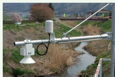
観測ポイントの水位を計測する水位計
