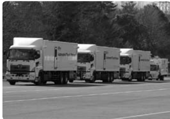
車間距離4mの自動運転・隊列走行の様子
