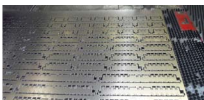
ネスティング技術による加工の様子
