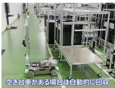
写真3 台車センシングによる自動空き台車回収
