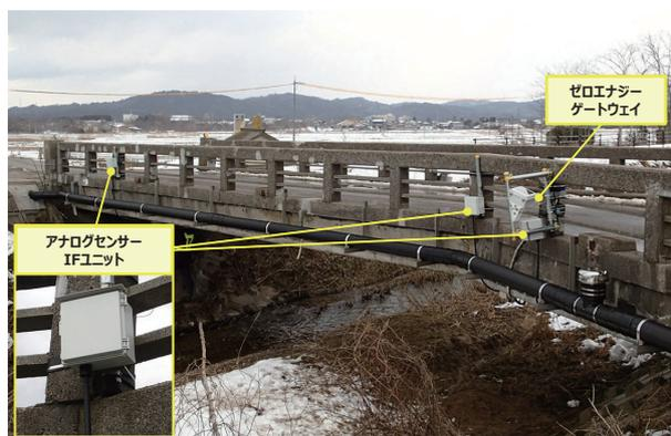
図3 橋梁塩害モニタリング
