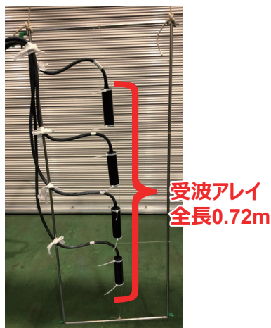
図2 実海面試験で実際に用いた受波アレイ
