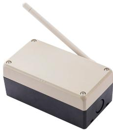
写真1 無線加速度センサーユニット 外観
