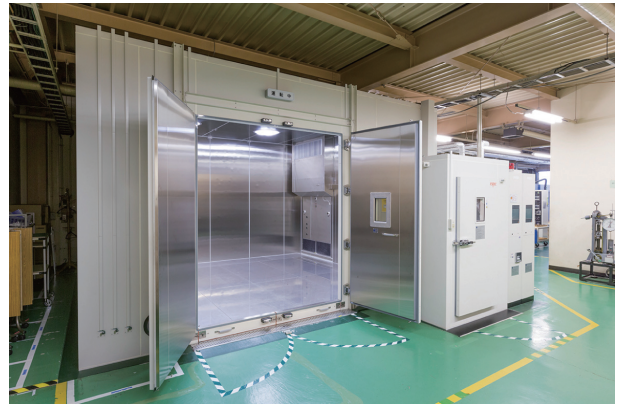
写真3 大型恒温恒湿試験装置
