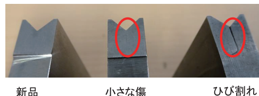
図5 プレス加工金型のひび割れ状況
