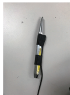
図6 ひび割れ検査に用いた金属棒とマイク
