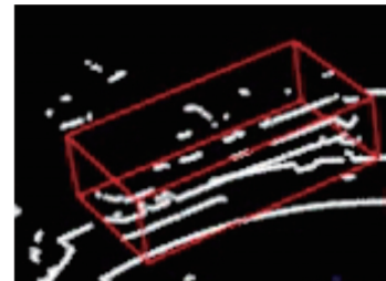
図 6(a) LiDAR による物体候補の例
