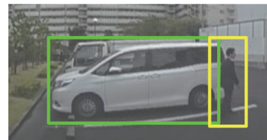
図 6(b) (a) の物体候補領域の画像データに基づく物体検出結果の例
