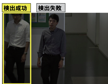
図2 照明が不十分で検出に失敗した例
