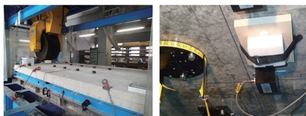
写真1 輪荷重走行試験機と無線加速度センサー
