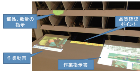
図4 プロジェクションマッピングによる作業指示
