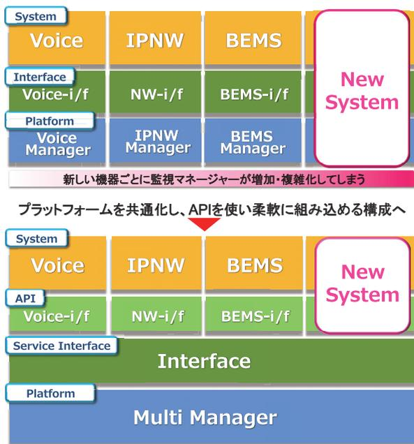
図6 APIを用いた監視システムの構成
