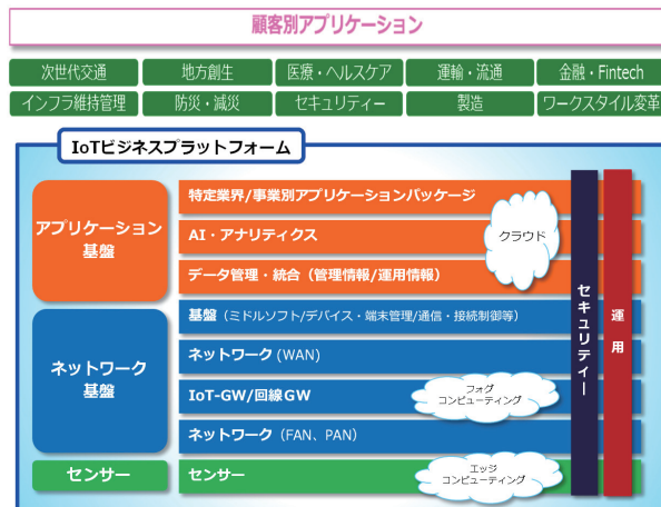
図4 IoTビジネスプラットフォームのレイヤー構造
