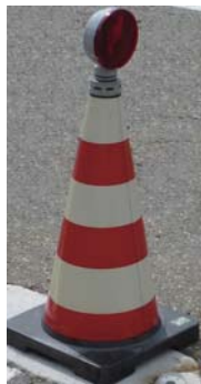
写真1 ラバーコーンに設置した無線センサーユニット
