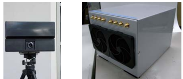
写真1 到来方向推定装置（左がアンテナ、右が本体）
