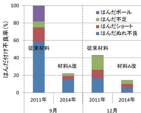
図6 材料A改導入による品質改善効果
