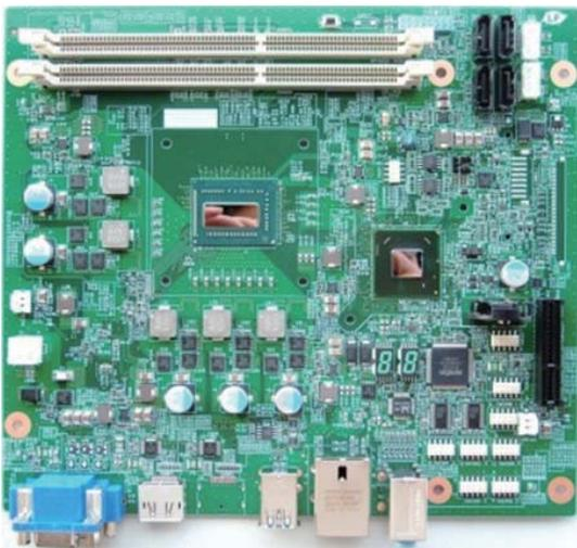
写真1 Ivy Bridge CPU ボード (長野 OKI 設計、製造)
