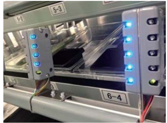
写真7 組立作業のナビゲーションシステム
