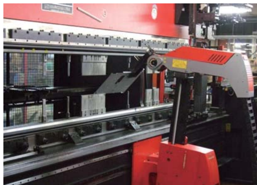
写真5 曲げ加工の自動化
