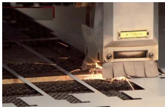
写真4 レーザーによる外形切断
