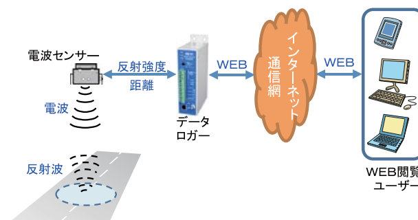
図1 Web監視水位計構成例
