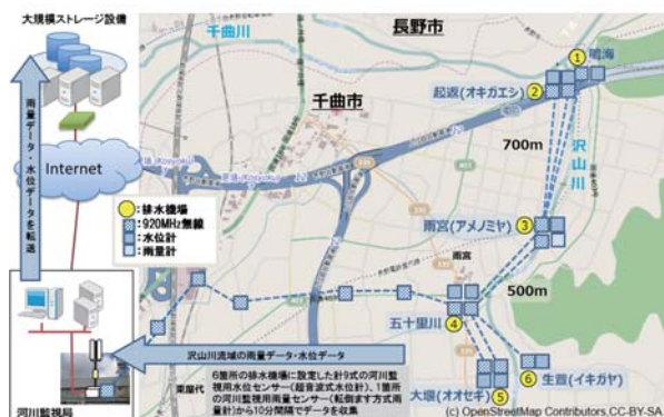
図3 千曲市沢山川に設置したシステム構成
