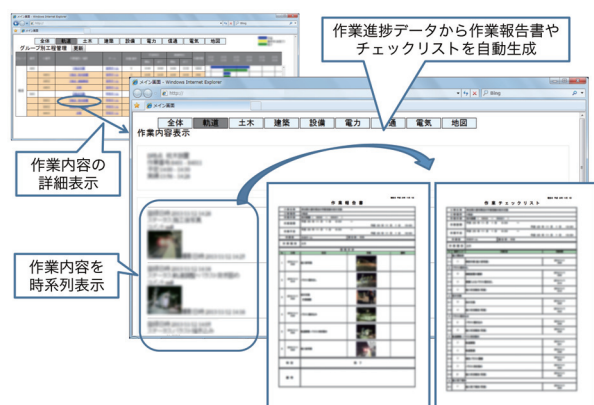
図6 作業詳細状況の確認と作業報告書の自動生成
