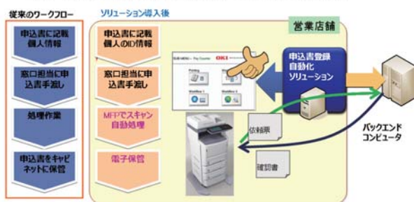
図6 オープンプラットフォーム利用システム構築例
