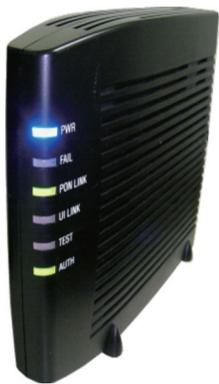
図3 開発した10G-EPON ONU 外観
