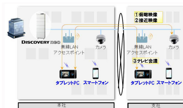
図4 俯瞰映像＋クリックツーコールのシステム構成
