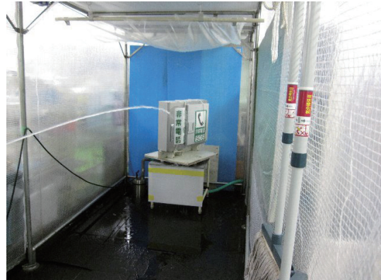
写真4 壁面収容箱の防水試験
