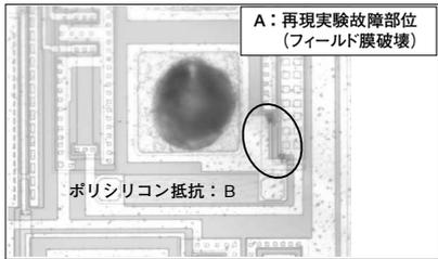
写真1 組立工程ESD損傷を再現した損傷箇所
