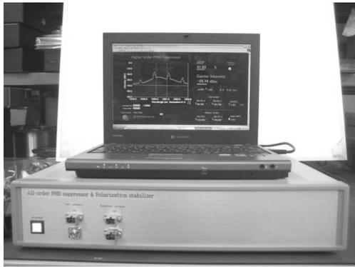
写真1 高次PMD抑圧器の試作器概観
