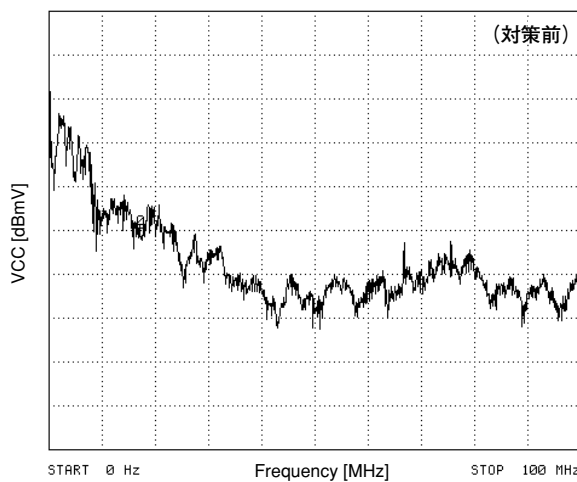
図3 駆動回路の電源電圧スペクトル測定結果
