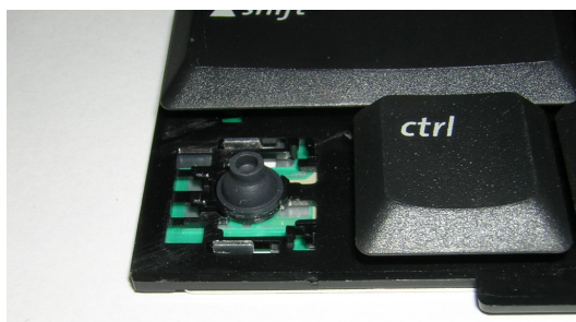
写真3 樹脂ベースを用いた構造
