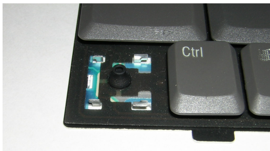
写真4 他社の金属ベースの構造例
