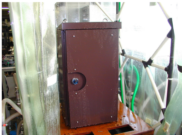
写真4 散水試験機による防水試験
