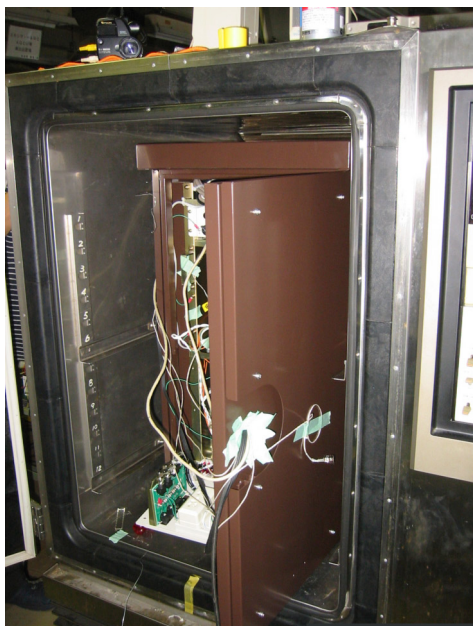
写真3 恒温槽による耐熱耐寒試験
