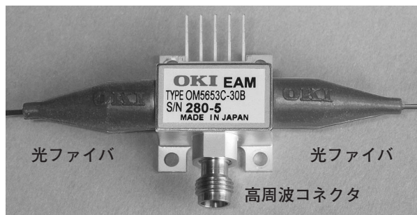
図1 EA変調器モジュールの外観写真
