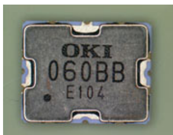
写真1 国内用CDMA方式SAWアンテナ分波器
