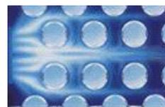
写真2 天然ガス燃焼型ボイラの水管群空間における燃焼状態
