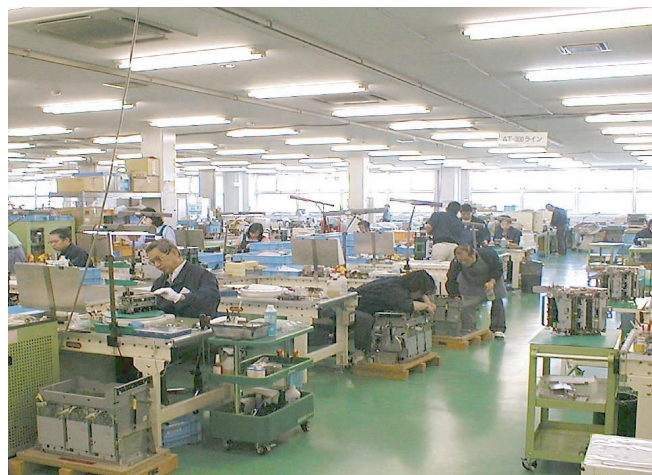
写真2 予備機、ユニット整備ライン
