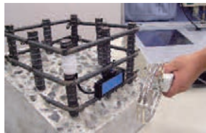
ひずみ計測システム
