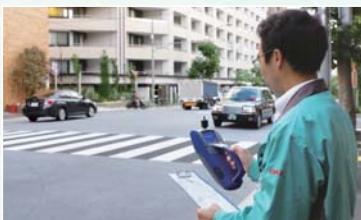
車道空気中のPM2.5の濃度測定
