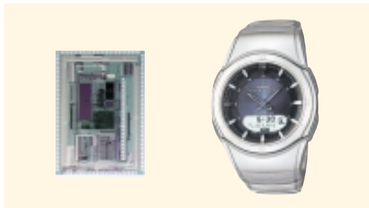
時計用カスタムLSI 0.35 SOIプロセスを用いて超低消費電力化を実現した、電波ソーラーウォッチ (写真提供:カシオ計算機株)
