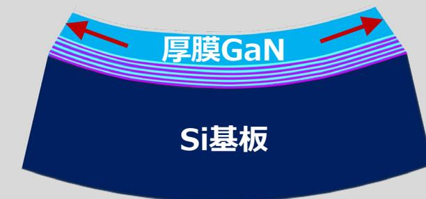
GaN on Siは、GaNとSiとの熱膨張係数が大きく違うため、引張応力で、大きく反る！
