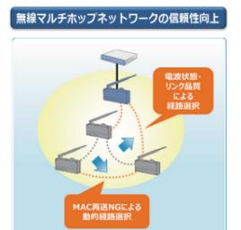
「SmartHop」無線通信モジュールは、複数の無線子機（中継機）を中継して通信経路を構成できるマルチホップ技術を採用し、各子機間の電波状態に応じて最適な経路を自動選択する仕組みによって、より高信頼の無線通信を実現しています。また、マルチホップに必要な機能やシリアル透過機能（アプリケーション層）まで無線モジュールに内蔵しているため、組み込み時の開発工数を大幅に削減できます。
