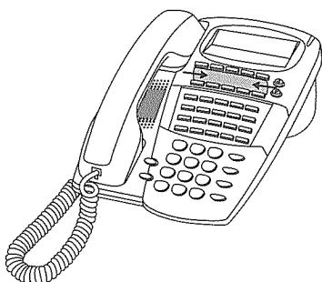
フレキシブルカバーの上側中央の切り込みに、シャープペンの先など先のとがったものを差し込み、引き上げます。
