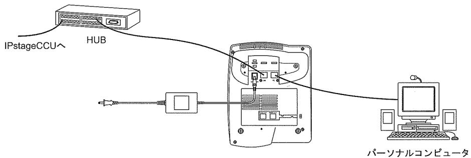
※ MKT／IPのLANポートとPCポートはブリッジとして接続されます。従って、LANポートをリピータHUBに接続した場合でもPCポートを1つのセグメント(多段接続)としてカウントする必要はありません。
