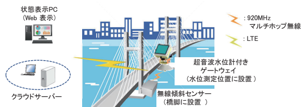
図7 鉄道橋梁モニタリング
