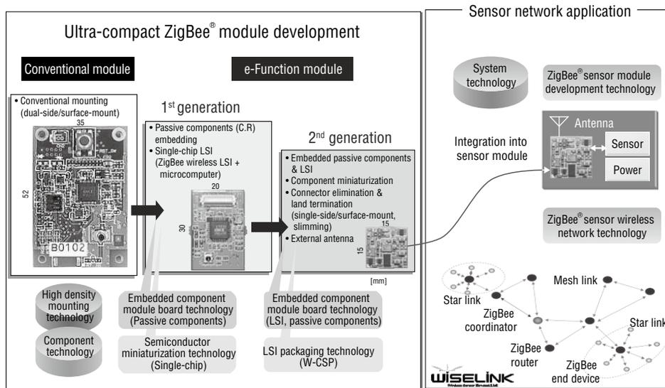
Figure 7. ZigBee® Module
